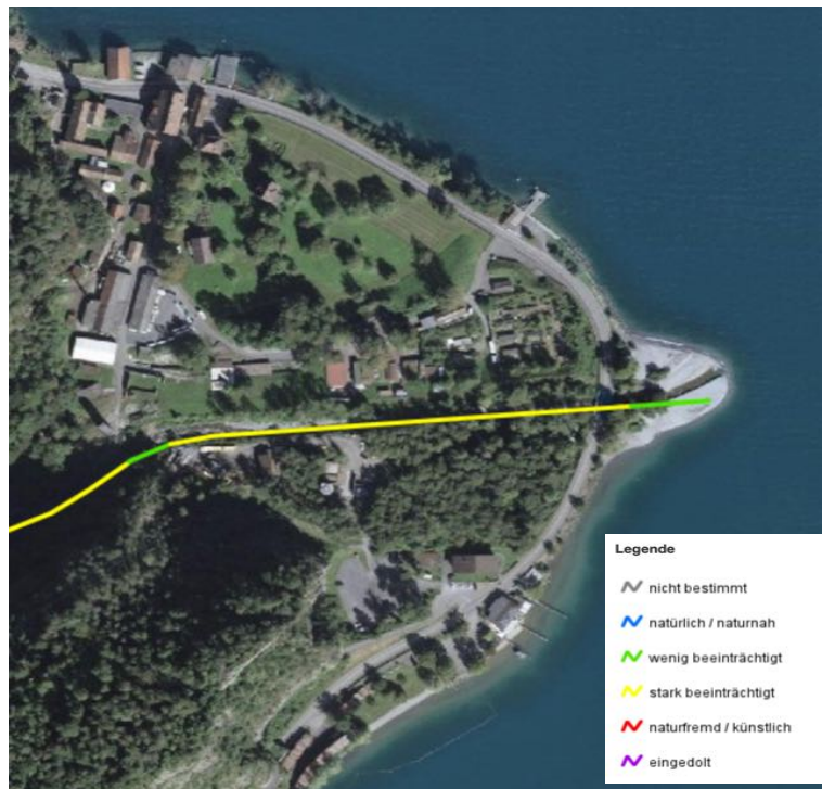
Abbildung 3: Ökomorphologischer Zustand des Isitalerbachs an der Isleten. Quelle: (Swisstopo, 2024b).
