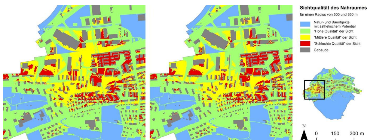
Abb. 32: Veränderung der Sichtqualität des Nahraumes, für unterschiedliche Radien (links 500 m, rechts 650 m)
