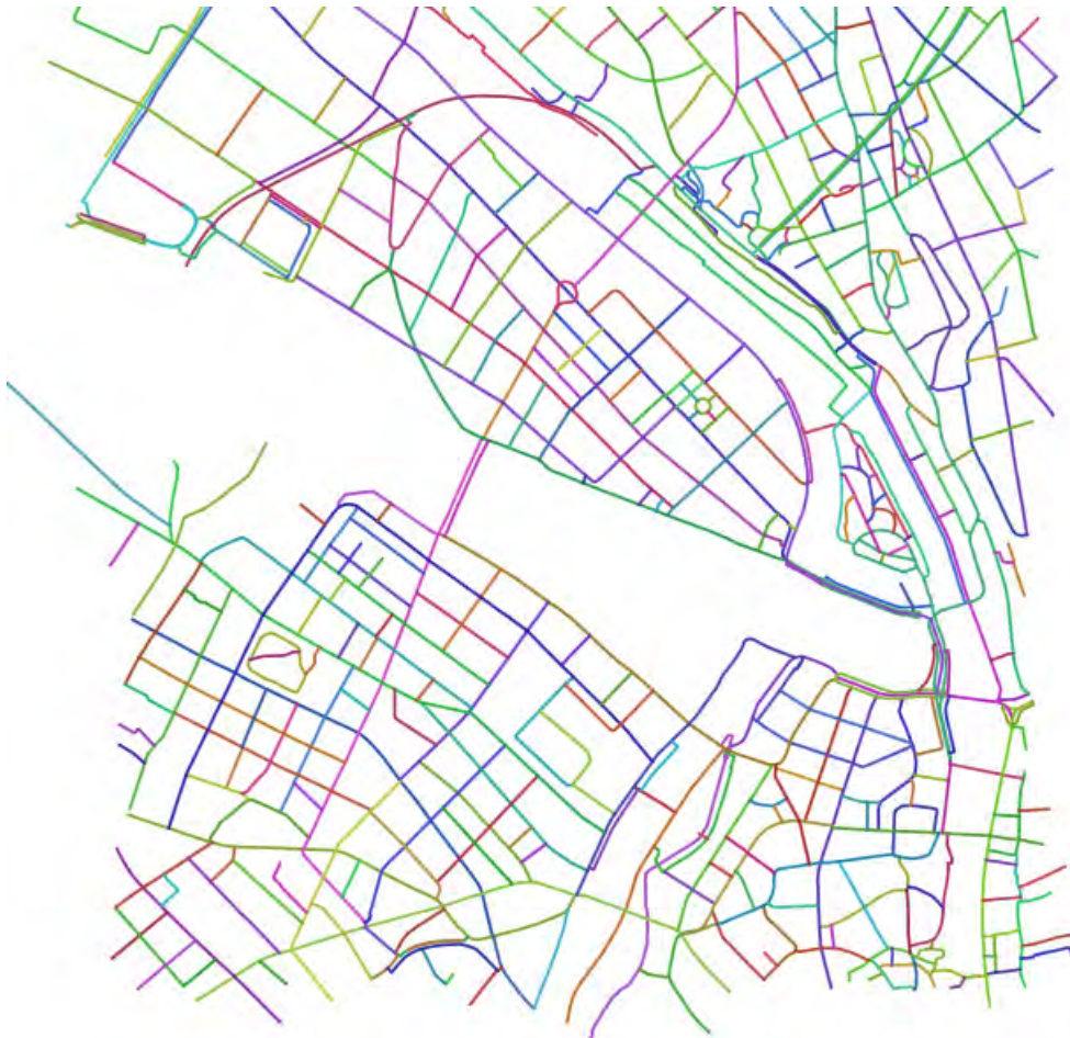
Abb. 19: Strokes aus dem Strassennetzwerk der Innenstadt von Zürich Die Strokes sind zufällig mit unterschiedlichen Farben eingefärbt. (© swisstopo)
