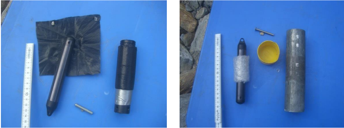
Abbildung 12: Loggervorrichtungen des Levelloggers und des Barologgers. Links: Levellogger mit der PE-Rohr-Vorrichtung (umhüllt mit Kunststoffmatte) und dem feinmaschigen Kunststoffnetz. Rechts: Barologger mit Schutzhülle. (Fotos: Daniel Eberhard, 19.07.2012).
