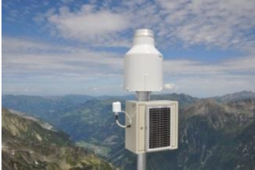
Abbildung 9: Messstation Ritzli mit beheizbarem Pluviometer nach dem Wägeprinzip (oben) und Temperatursensor (links). (Bild aus OTT Hydrometrie AG, 2013).
