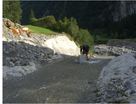
Abbildung 11: Standort des Levelloggers (rot) am Abflusspunkt des Einzugsgebietes, eingebohrt in die Mischbetonschicht auf dem Galeriedach. Das Foto rechts zeigt den Standort mit der Einmündung des Spreitgrabens in die Aare im Hintergrund. (Fotos: Daniel Eberhard und Florian Frank, 28.08.2012).
