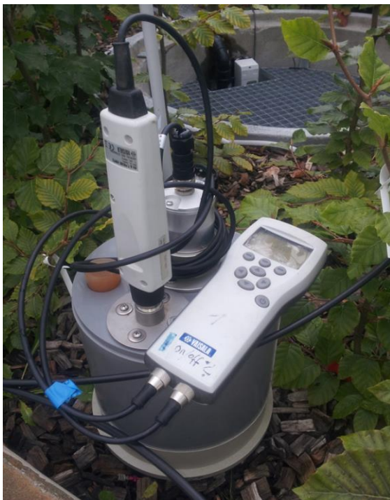
Abb. 9: Dynamisches geschlossenes Kammersystem zur Messung der CO 2 -Oberflächenflüsse.
