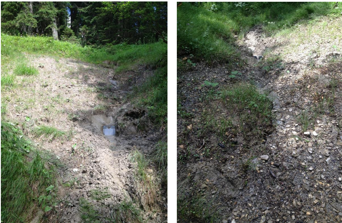
Abb. 29. Die nahe Umgebung des Quellstandorts 81.2. Der Abfluss wird in der grauen Utz Box gemessen (Foto: Herrmann, 25.7.2013).
