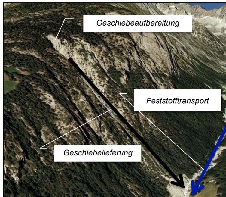
Abbildung 12: Prozessablauf des Geschiebehaushalts im Zusammenhang mit fluviatilem Feststofftransport am Beispiel des Baltschiederbachs bei Tuntscheta auf 1013 m.ü.M (© Google Earth).
