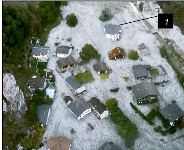
*Abbildung 77: Kalibrierungsphoto mit stark mit Sediment überschüttetem Bereich vor Gebäude Nr.1, in welchem es in der Simulation zu keinen Ablagerungen kommt (Photo: Andreas Götz).*
