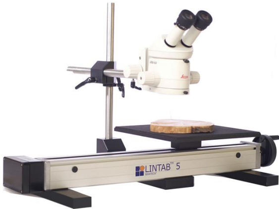
Abb. 22 Lintab Messtisch, Quelle www.rinntech.de
