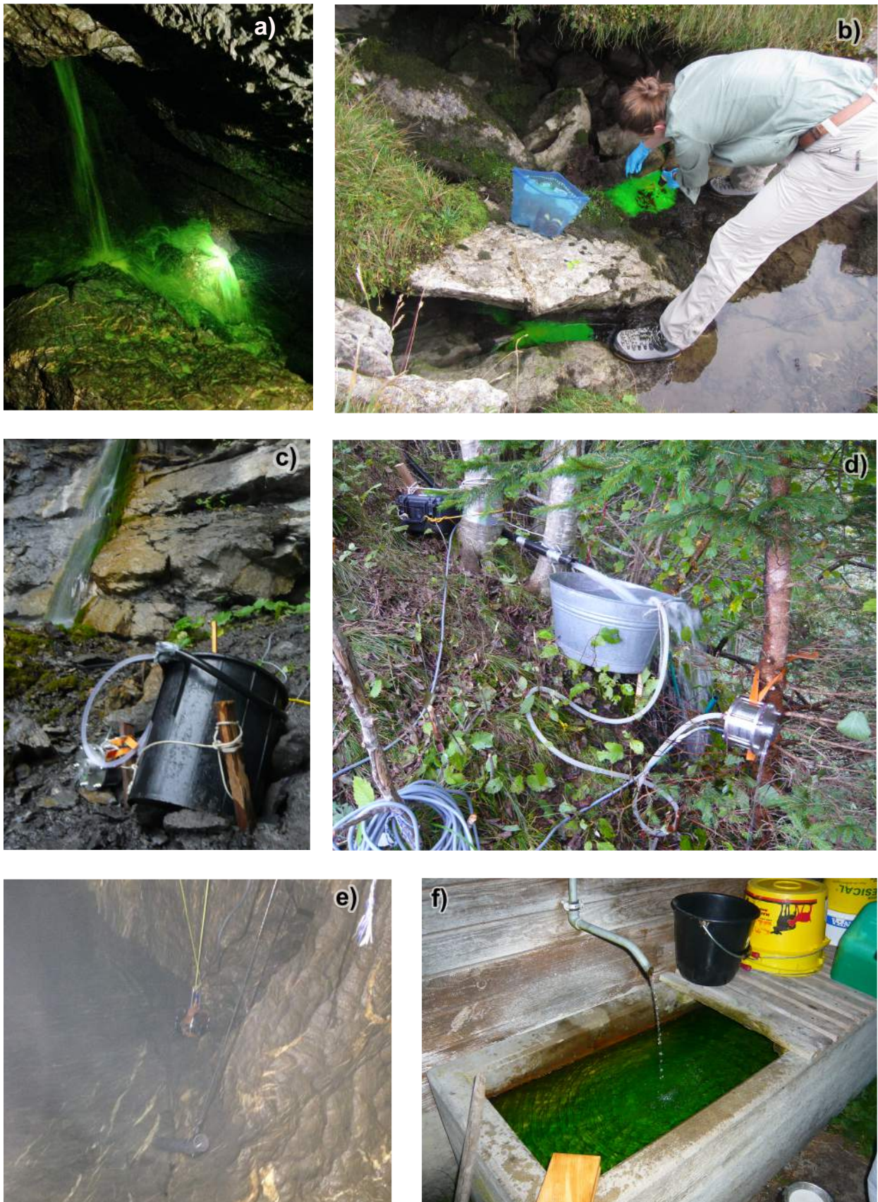
Abbildung 4.6: a) Wasserfall von Riedloch mit Uranin gefärbt (2-RL). b) Injektion bei Riedloch mit Uranin (2-RL). c) Fluorometerinstallation bei Krähloch. d) Fluorometerinstallation bei FUR. e) Fluorometer im ersten See der Kreuzlochhöhle, über dem Seeabfluss und Drucklogger. f) Brunnen bei Furli mit gefärbtem Wasser (3-WA).
