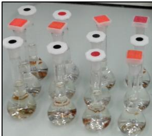
Abb. 17: Oxalataufschluss bereit zur Messung mittels AAS
