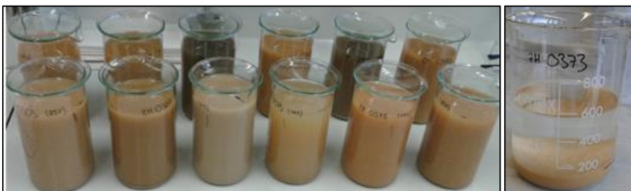
Abb. 15: Aufgewirbelte Tonsuspension und sedimentierte Tonfraktion
