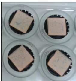
Abb. 16: Mit EG gesättigte Tonproben auf Glasplättchen und XRD-Halterung
