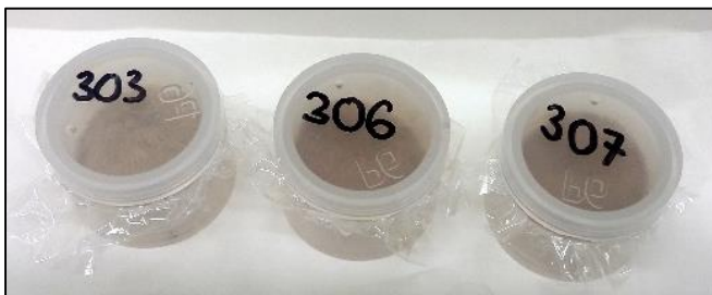
Abb. 14: Pulverproben (Profil 897) bereit zur Messung mittels XRF
