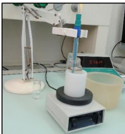
Abb. 18: pH-Elektrode mit verwendetem Gefäss für die Batch Säure Experimente
