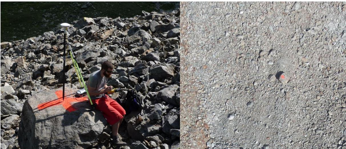
Abbildung 5.5: Einmessen der Kontrollpunkte mittels DGPS, welche im Luftbild (rechts) erkennbar sind. Eigene Fotografie.
