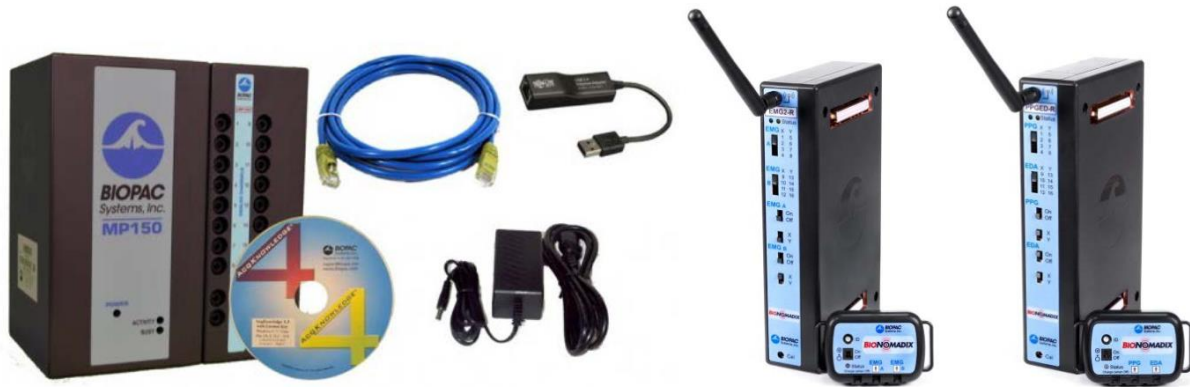
Abb. 3-22 | BIOPAC MP150, EMG2-R und PPGED-R (v.l.n.r.)
