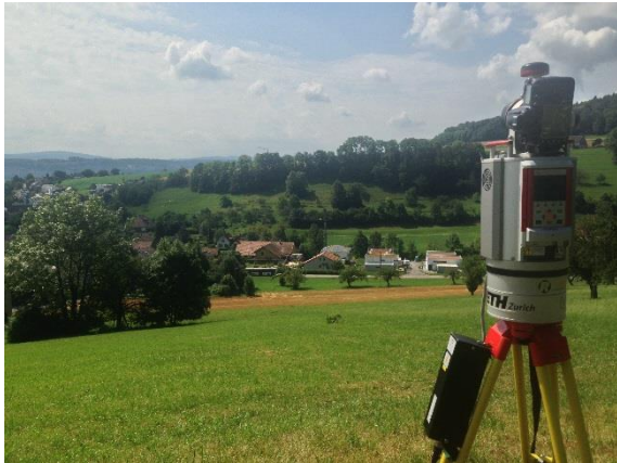
Abb. 3-7 | VZ-1000 von Riegel mit Nikon D700
