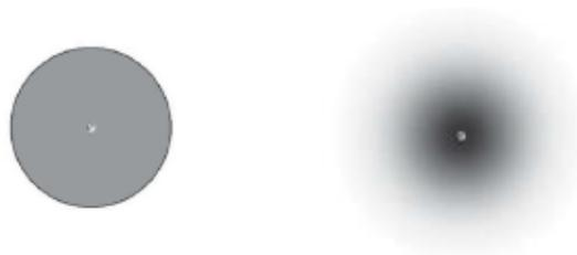
Abb. 15: Zwei extrinsische Methoden, um räumliche Unsicherheiten darzustellen. Links: Methode nach Google Maps, rechts: *Gaussian fade* nach McKenzie *et al.* (2016).
