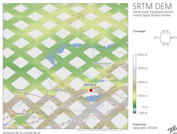
Abbildung 33: SRTM X-Band Abdeckung über der Kirgisischen-Kasachischen Landesgrenze mit Position des Tujuksu-Gletschers (roter Punkt) südlich von Almaty (URL SRTM X-Band)
