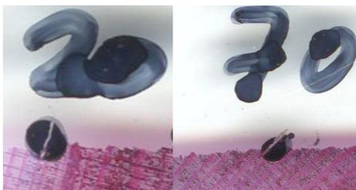
Abbildung 52 Beschriftungsmethode mit einer dünnen Nadel
