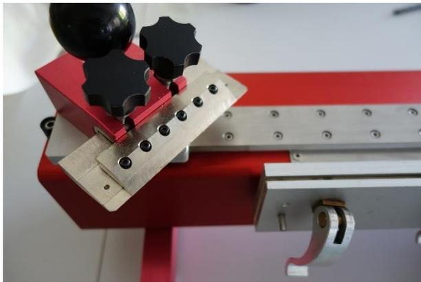
Abbildung 35 lange Variante des WSL- Holzmikrotoms (eigenes Bild)
