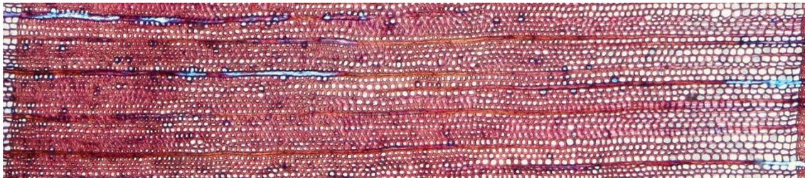
Abbildung 53 Druckholzzellen über die gesamte Breite des Jahrringes, auch im Frühholz (eigenes Bild)
