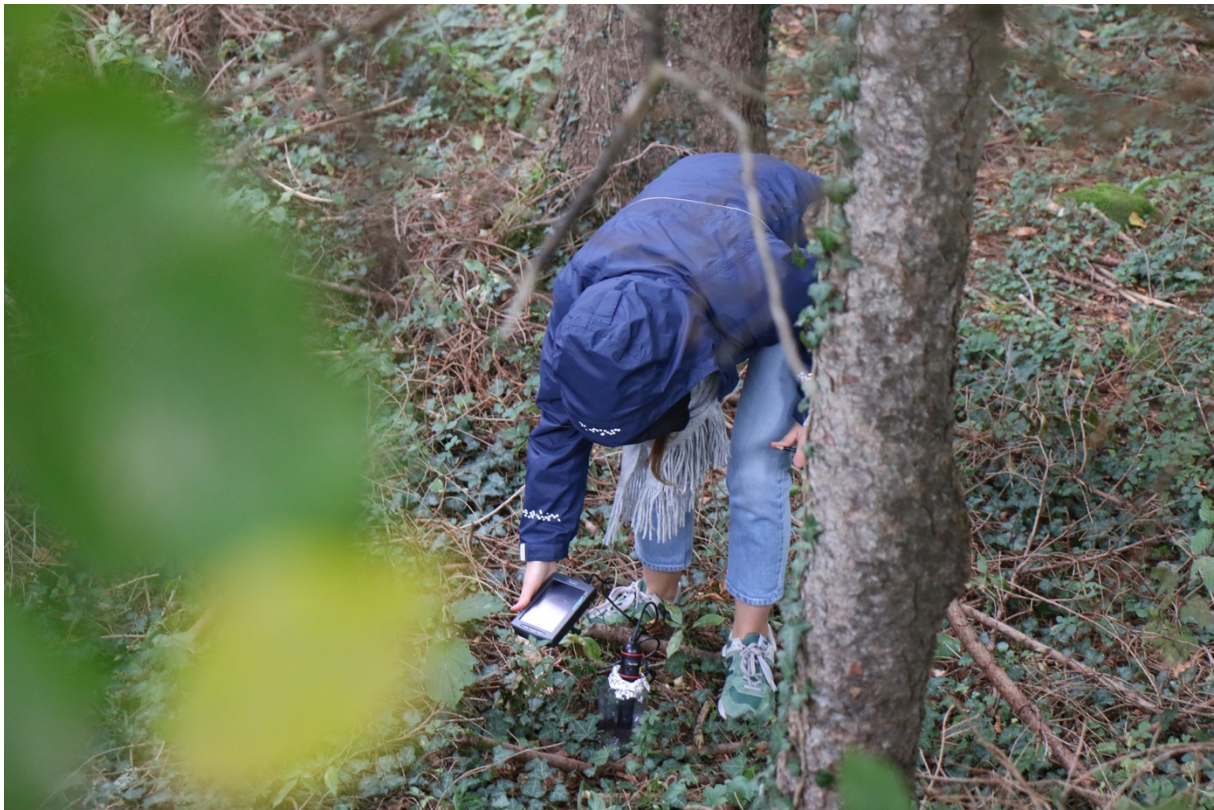
Abbildung 21: Eine Exkursionsteilnehmerin misst die CO 2 -Bodenatmung des Waldbodens (eigene Aufnahme).
