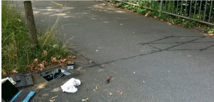
Abbildung A-16: Zählgerät an der Sihlpromenade, Zürich: Induktionsschlaufen (rechts) und das im Boden versenkte Zählgerät (links) (Dorbritz & Wirz, 2020)
