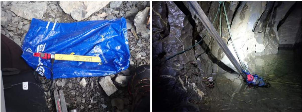
**Abbildung A.9.:** *Blinks: RBR Drucklogger, rechts: Turner C3 Fluorometer, montiert im Kreuzloch. Bilder: Martin Lüthi*
