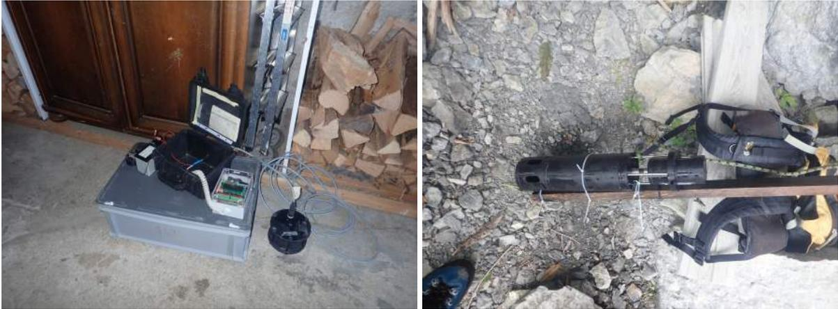
**Abbildung 3.2.:** Links: GGUN FL30 Fluorometer von Albillia. 3 dieser Geräte wurden im Rahmen dieser Arbeit eingesetzt. Zu sehen ist das Messgerät ganz rechts, daneben auf der Box der Computer/Logger sowie die wasserdichte Box. Links ist die angeschlossene 12V Batterie zu sehen. Rechts: Truner C3, an einer Stange montiert für den Einsatz im Kreuzloch. Bilder: Martin Lüthi, eigene Aufnahme
