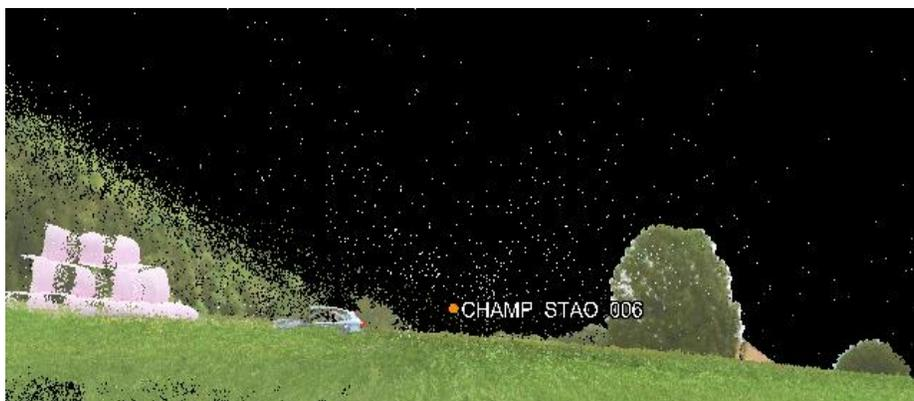
**Abbildung 3-7** Punktwolke vor der Säuberung, erkennbar an den weissen Punkten rund um eine Scanposition von Champoz (CHAMP STAO 006) (eigene Darstellung).
