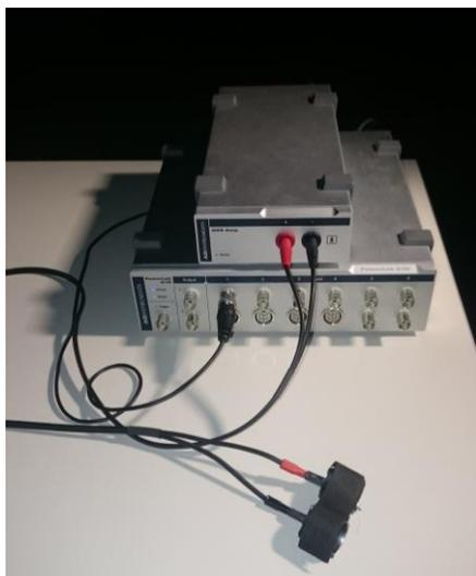
**Abbildung 3-14** Geräte von ADInstruments: Das Powerlab (unten) und der Verstärker (oben) mit den verbundenen Elektroden für die Finger (eigene Aufnahme).
