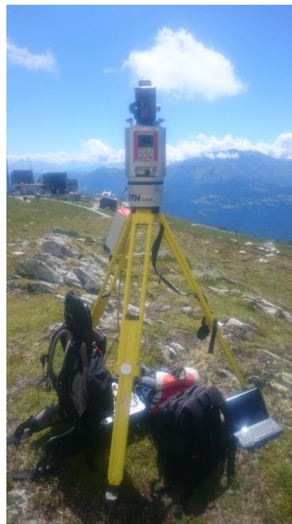
**Abbildung 3-1** TLS Riegl VZ-1000 mit der NIKON D700 Kamera (eigene Aufnahme).
