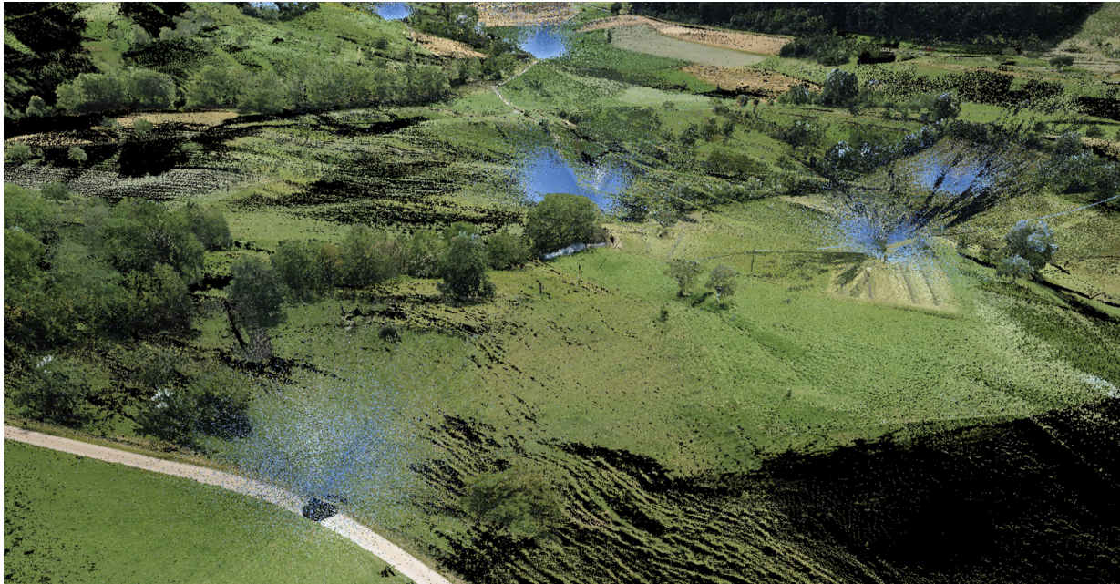
ABB. A.11: Airpoints in den TLS Daten - Visualisiert in RiSCAN PRO
