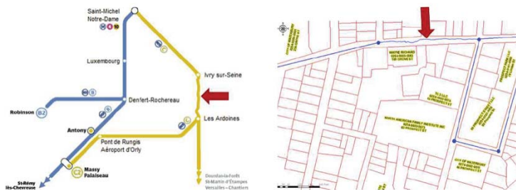
Abb. 5.3: Beispiele der sketchy Line Methode durch BOUKHELIFA et al. (2012: Figure 7). Links angewandt auf einem Bahnnetz Schema und rechts auf einer Katasterkarte. Unsichere Linien sind durch einen roten Pfeil hervorgehoben
