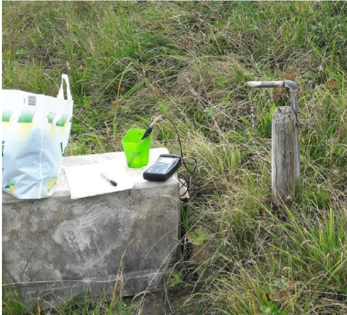
Abbildung 23: Conductimeter (WTW Multi 3430) misst die elektrische Leitfähigkeit und die Wassertemperatur im Gefäss mit dem der Abfluss gemessen wurde. Quelle 23.
