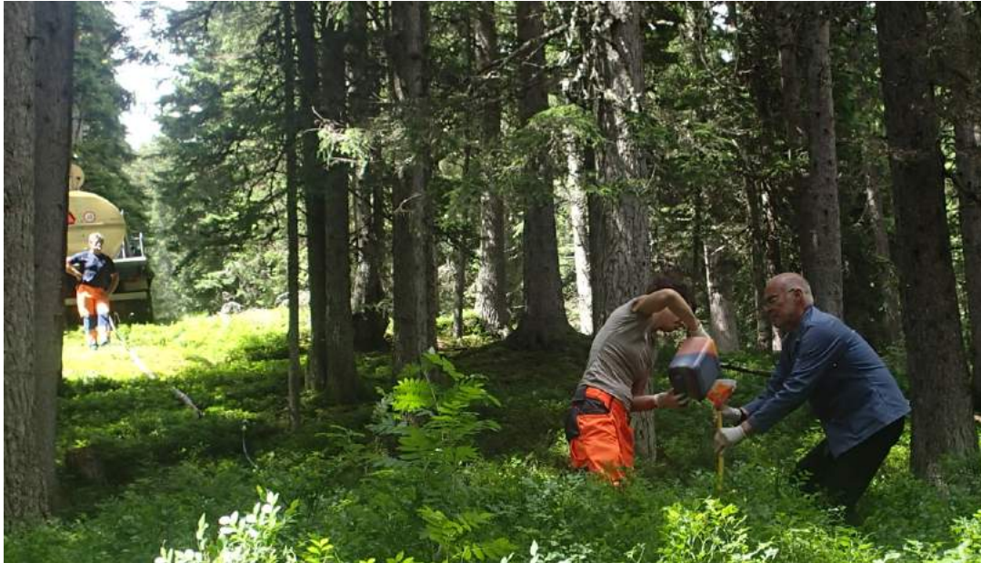
Abbildung 20: Tracerinjektion: Im Vordergrund wird einer von zwei Kanister (je 0.5 kg gelöstes Uranin) in den Trichter eingefüllt. Im Hintergrund steht der Tankkaster der Feuerwehr Grindelwald (3 m 3 ).
