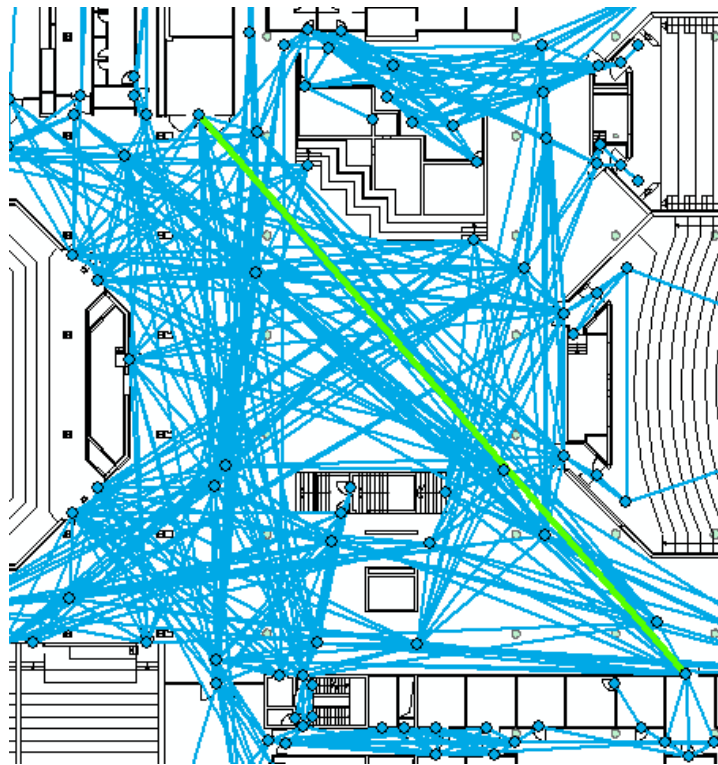
Abbildung 83: Das Sichtbarkeits-Netzwerkmodell (blau) in der Freiflächen-Umgebung mit dem Pfad des Einfachsten-Weg-Algorithmus (hellgrün).
