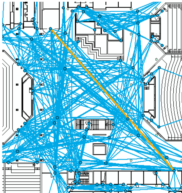
Abbildung 81: Das Sichtbarkeits-Netzwerkmodell (blau) in der Freiflächen-Umgebung mit dem Pfad des Kürzesten-Weg-Algorithmus (orange).
