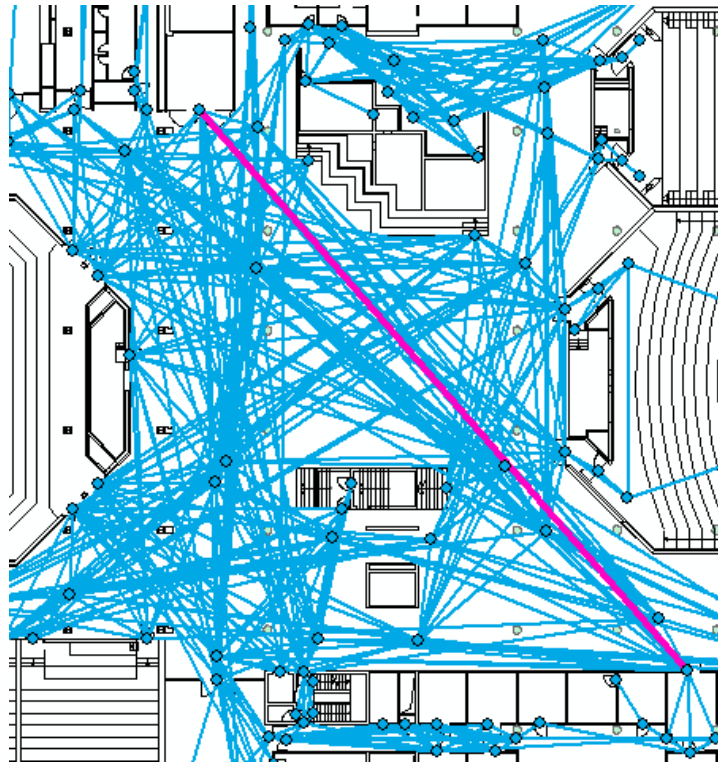
Abbildung 82: Das Sichtbarkeits-Netzwerkmodell (blau) in der Freiflächen-Umgebung mit dem Pfad des Abbiegungs-Algorithmus (pink).
