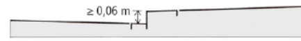
Figure 7: High curb edges with a vertical offset of 0.06 m (Schweizerischer Verband der Strassen- und Verkehrsfachleute VSS, 2014).
